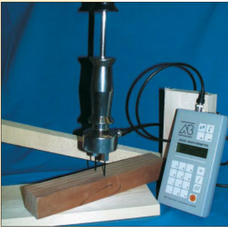
Weerstandsmeter met slagelektrode
