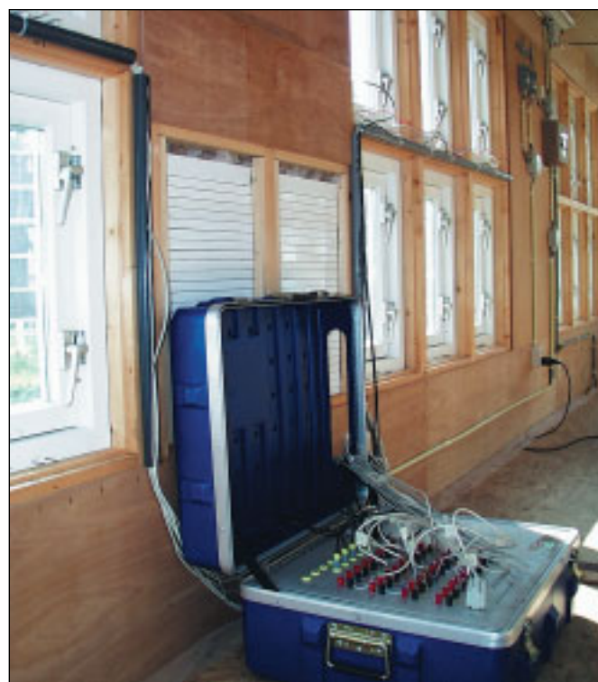
Mobiel 32 kanaals meetstelsel in een testopstelling
