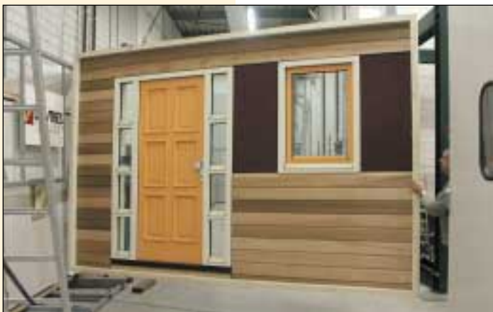
Het eerste gevelvullende testelement van De Vries Kozijnen wordt door de laboratoriumgangen van SHR naar de WW- hal gehesen.
