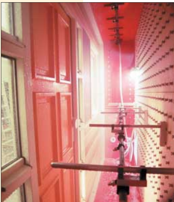
De besproei-installatie in actie - 30 l per minuut.
