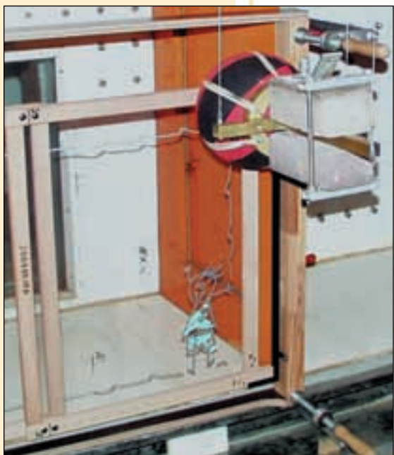
Slagbeproeving van een experimenteel traphekje volgens prEN 1930
