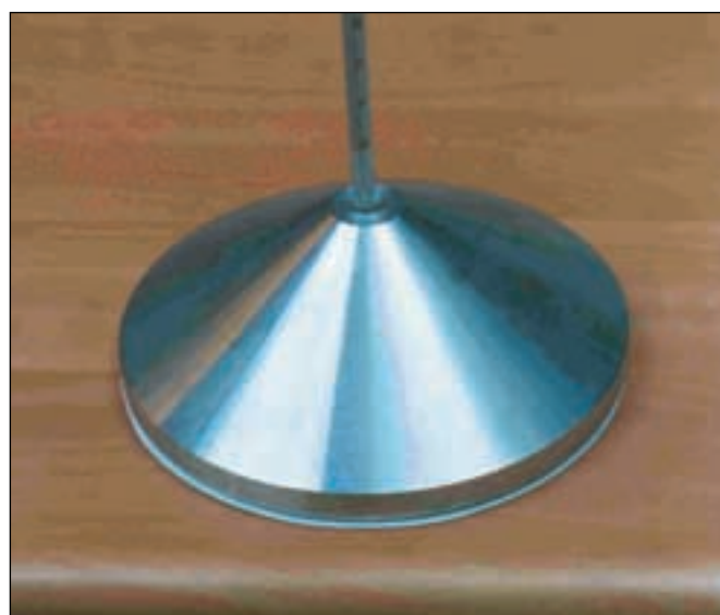
Vaststellen van de hittebestendigheid van een keukenblad volgens EN 438
