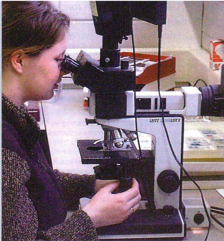
Een medewerker van SHR onderzoekt de oorzaak en aard van de aantasting in een houten funderingspaal.
