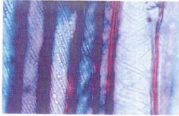
Microscopische opname van grenen met softrot aantasting
