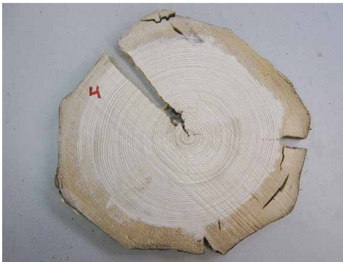
Paal onder paleis op de dam, in ruim 350 jaar slechts een door bacteriën aangetaste schil van 15 mm en de aantasting is niet meer actief.
