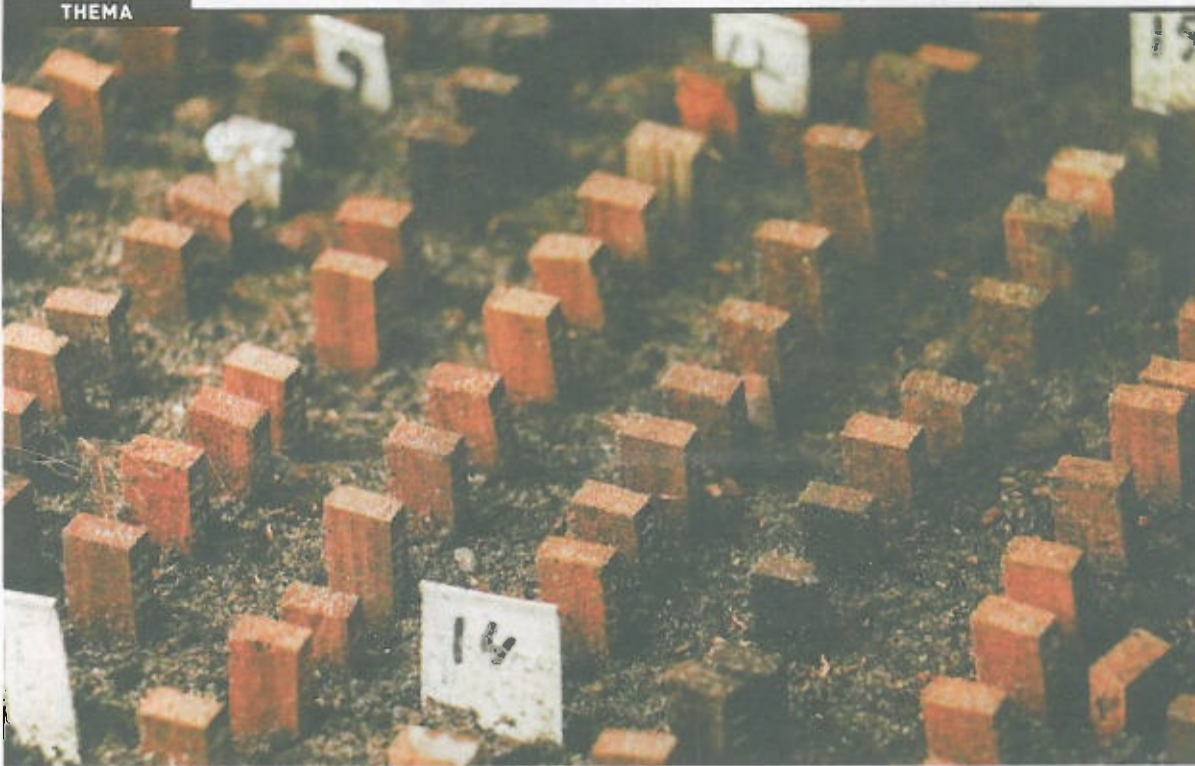
▲ Diverse houtsoorten worden getest op hun reactie op vocht en bodemcontact. (foto: Daniël Wiersma)
