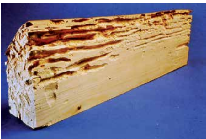
Aantasting houtboktor in vuren (foto: FCBA).
