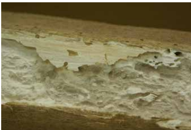
Aantasting spint-houtkever in spint van robinia (foto: SHR).
