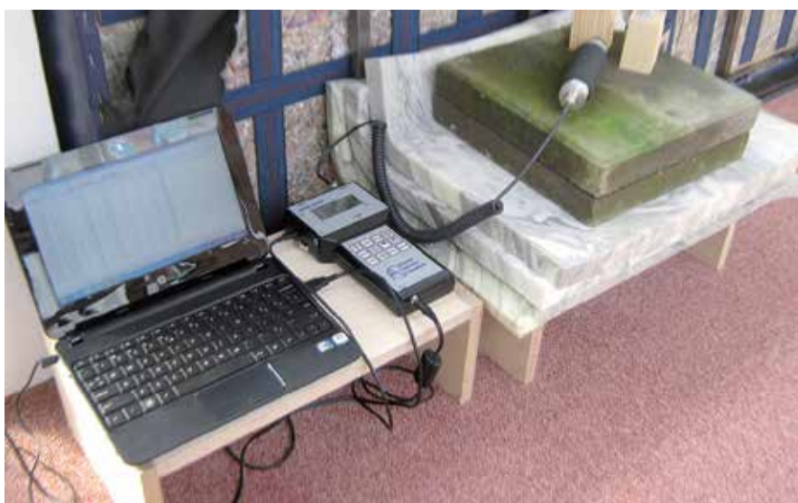
Opstelling meerdaagse test met huisborktor (foto SHR).
