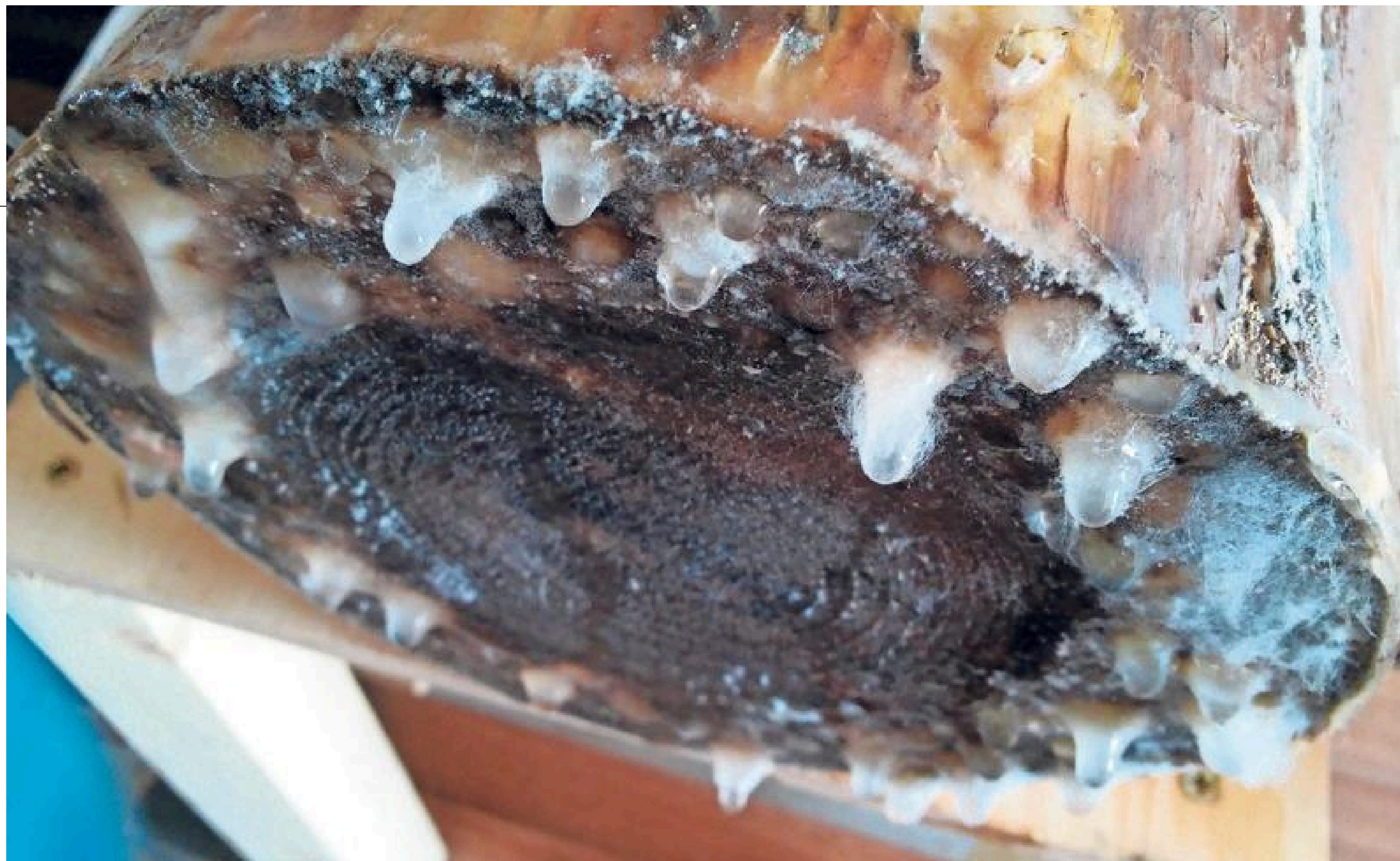
Slijmvorming onderaan een grenenhouten stam. Suiker opgelost in water stimuleert die slijmvorming en werkt daardoor conserverend.
