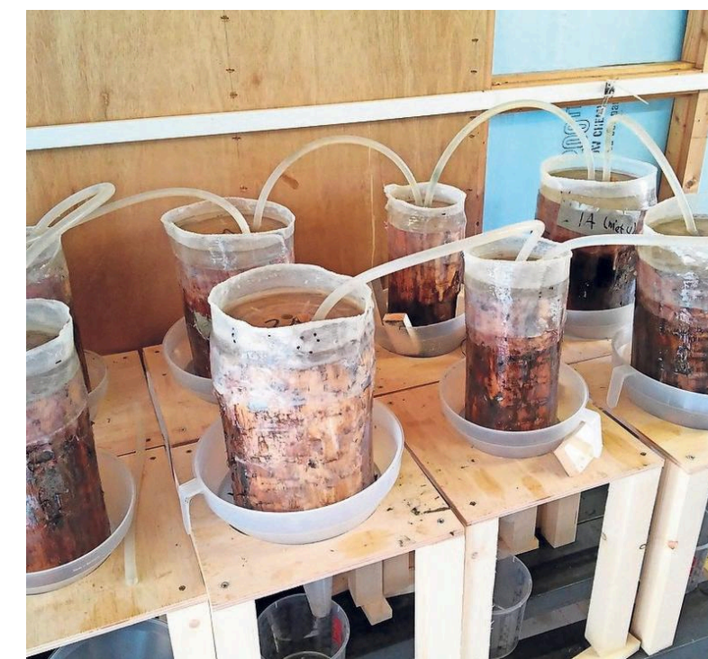
Water loopt door in epoxyhars verpakte stammen en wordt opgevangen.
