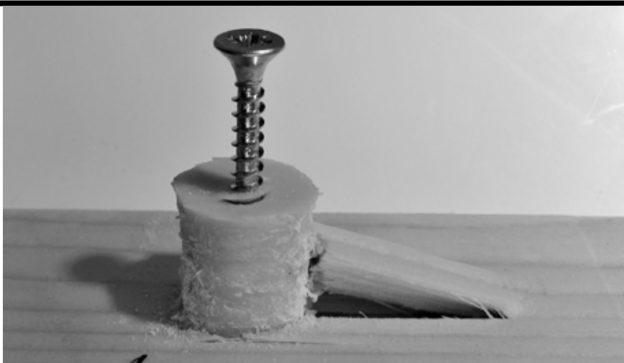
Voorbeeld testreparatie na bepaling schroef- uittrekwaarde.
