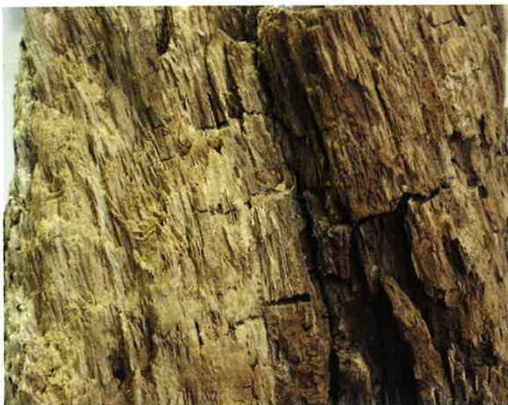
Stuk eikenhout dat tegelijk is aangetast door witrot (links) en bruinrot (rechts). Foto: SHR
