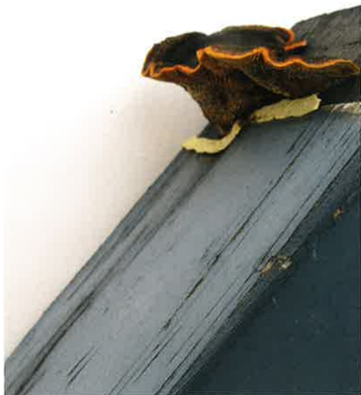
Vruchtlichaam van plaatjeshoutzwam op proefkozijn. Foto: SHR
