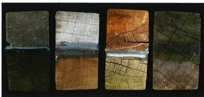
Scheurvorming in onafgewerkt en niet afgedicht hout. V.l.n.r. jatoba, guariuba, lariks (gelamineerd / gevingerlast) en sapeli. Boven de geëxposeerde zijde en onder de beschutte zijde
