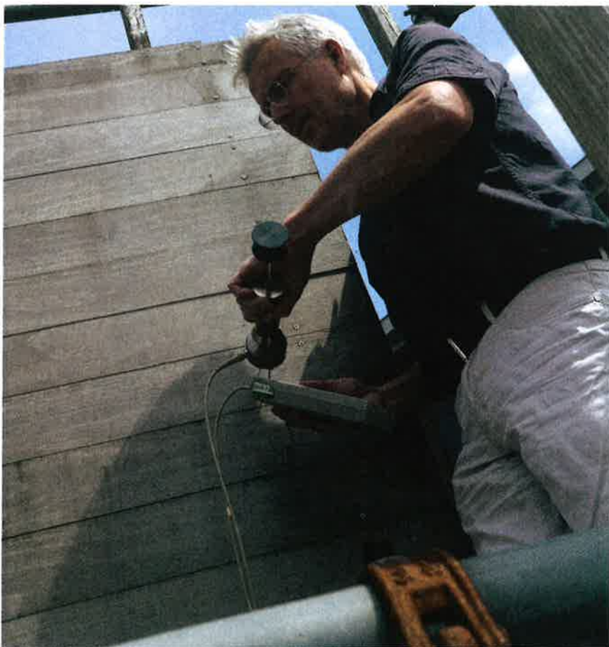
René Klaassen voert vochtmetingen uit bij proefopstellingen van hout bij SHR Wageningen om later te kunnen voorspellen welke invloeden een rol spelen bij vervorming.
