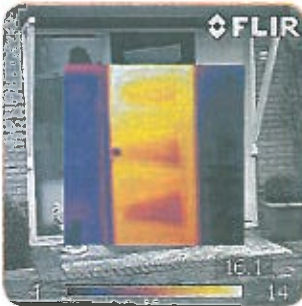
Infra-rood fotografie die op basis van temperatuur warmtelekage zichtbaar maakt.
